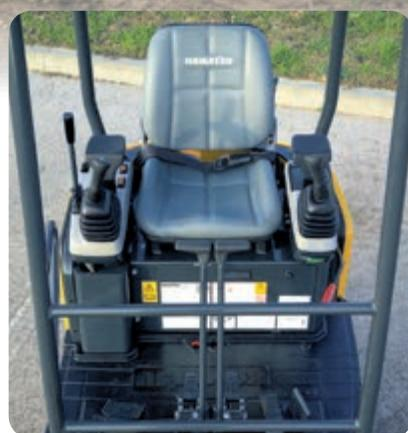
Rularea cu două viteze se activează printr-un schimbator de pe panoul de comandă. Panoul de comandă permite de asemenea operatorului monitorizarea tuturor funcțiilor masinii.
